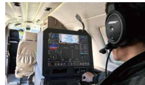
**飛行検査業務** 専用航空機で管制システム、航法システムの電波状態を検査
